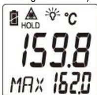
1. Zielen Sie mit dem Gerät und seiner Linse (④) auf das Messobjekt und drücken Sie den Messknopf (⑥) um sich die Oberflächentemperatur anzeigen zu lassen.
