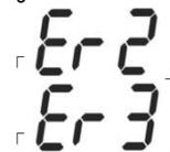
'Er2' wird angezeigt, wenn sich die Umgebungstemperatur rapide ändert. 'Er3' wird angezeigt, wenn die Umgebungstemperatur unter 0°C(32°F) oder über +50°C (122°F) liegt. Vor Gebrauch sollte sich das Gerät der Umgebungstemperatur anpassen können (kann bis zu 30 Minuten dauern).
